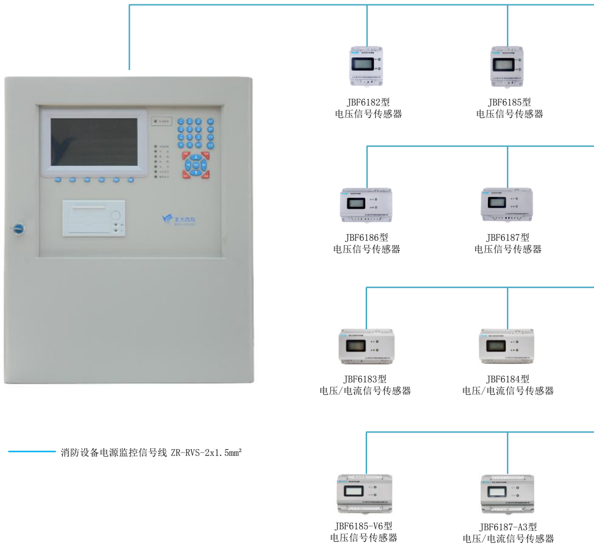
消防设备电源监控系统构成示意图
