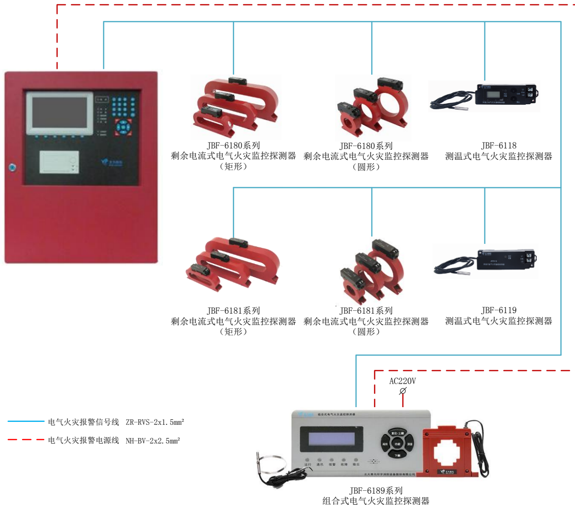
电气火灾监控系统构成示意图
